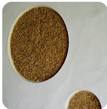
© Chanvriers en Circuits Courts - Enduit chanvre
