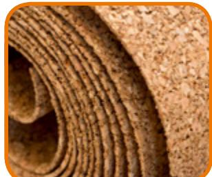
Les panneaux et rouleaux de liège sont fabriqués à partir de l'écorce de chêne-liège ou de bouchons de liège.
