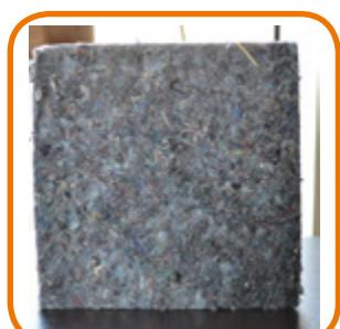
Le textile recyclé peut être conditionné sous forme de panneaux et rouleaux.
