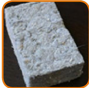
La ouate de cellulose peut être conditionnée sous forme de panneaux.
