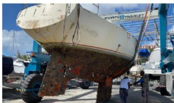
Figure 28: Sortie BHU E à l'aide d'une grue
