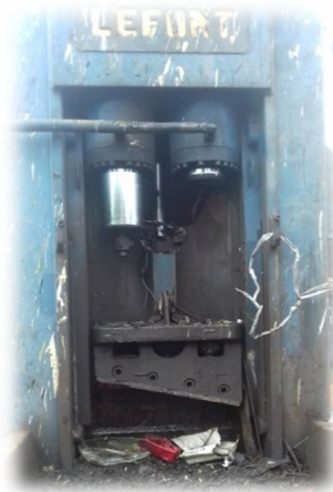
Figure 17 - Guillotine à ferrailles - SOURCE : Metal DOM
