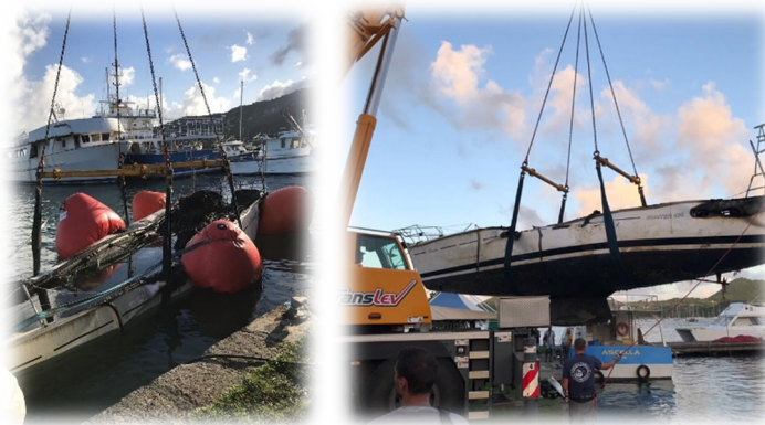
Figure 11 - Ballons et grue de levage – SOURCE : Sté. Service Plongée
